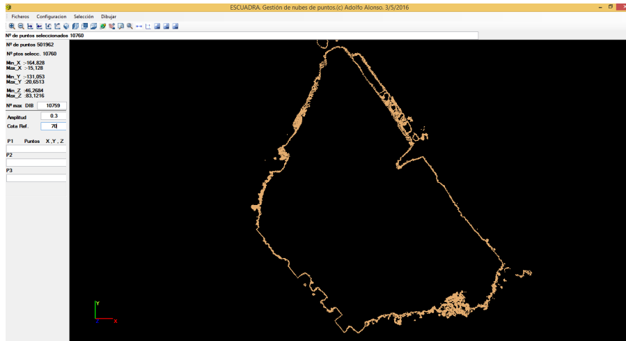
FIG. 31. Programa Escuadra. Sección horizontal de 0.30 m. de amplitud a cota 70 m.s.n.m. En esta sección se hallan un total de 10759 puntos. Se aprecian volúmenes del recinto inferior.
