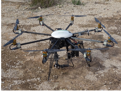
FIG. 6. Cuerpo del dron (sobre soporte) formado por ocho brazos y ocho hélices.
