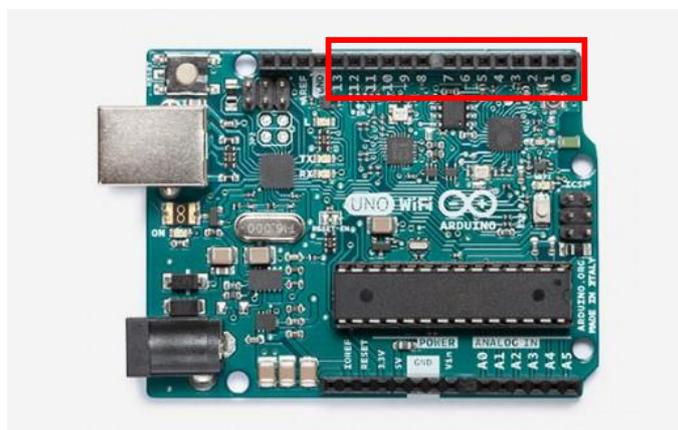
Figura 18: Entradas y salidas digitales de la placa del Arduino Uno Wifi (Fuente: Arduino.CC)
