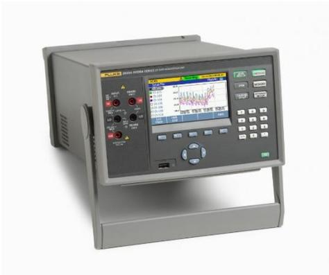
Sistema de adquisición de datos FLUKE 2639 (HYDRA III). Sistema de adquisición de datos de múltiples canales y alta exactitud para medidas de parámetros eléctricos, temperatura y sensores en entornos industriales, calidad y producción. Incorpora entradas de medida frontales y pantalla gráfica a color para ser usado como multímetro de banco. Con comunicación USB y Ethernet [14].
