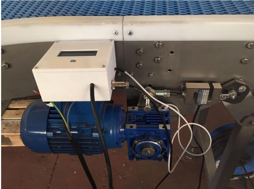
Figura 101: Posicionamiento del sensor de efecto hall y del imán (Fuente: Propia)
