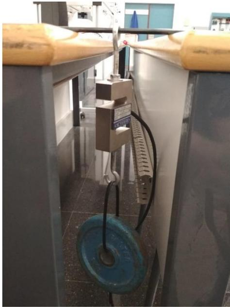
Figura 93: Posicionamiento de la célula de carga con un peso de 1,02 kg (Fuente: Propia)
