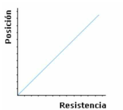
Figura 28: Potenciómetro de variación lineal (Fuente: Ingmecafenix)
