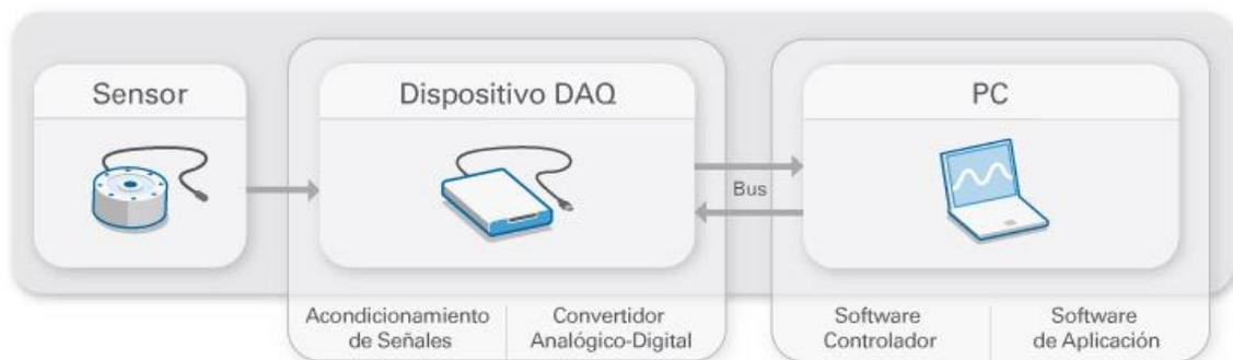
Figura 1: Partes que conforman un sistema de adquisición de datos (DAQ) (Fuente: National Instruments (NI))
