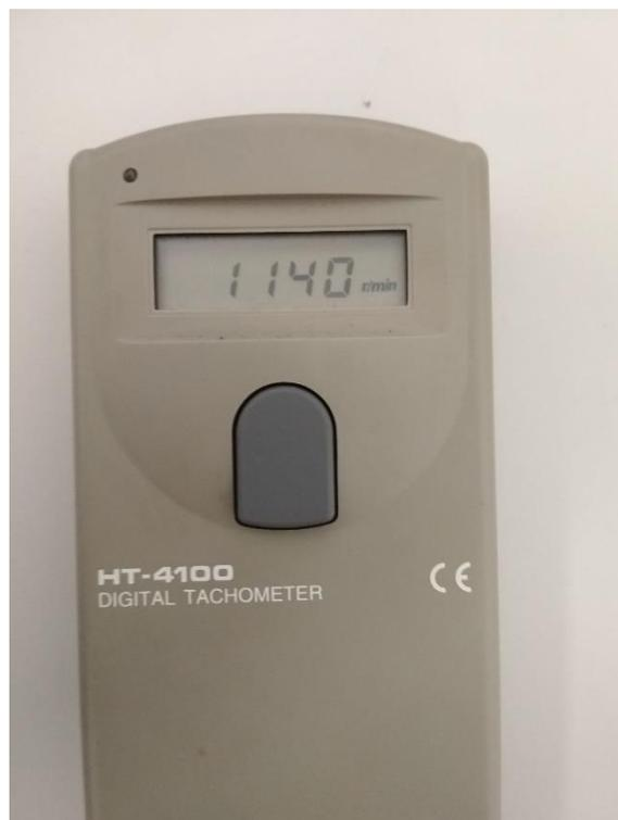
Figura 97: Medida de velocidad (rpm) con el tacómetro digital (Fuente: Propia)
