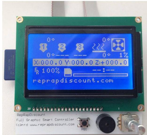
Figura 34: Display LCD en matriz de puntos (Fuente: zonamaker)
