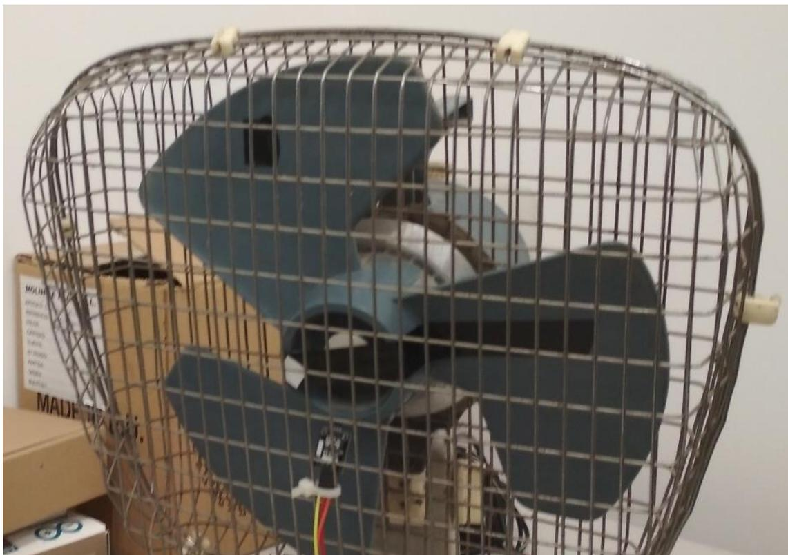
Figura 95: Posicionamiento del imán de neodimio, adhesivo del tacómetro digital y sensor de efecto hall (Fuente: Propia)
