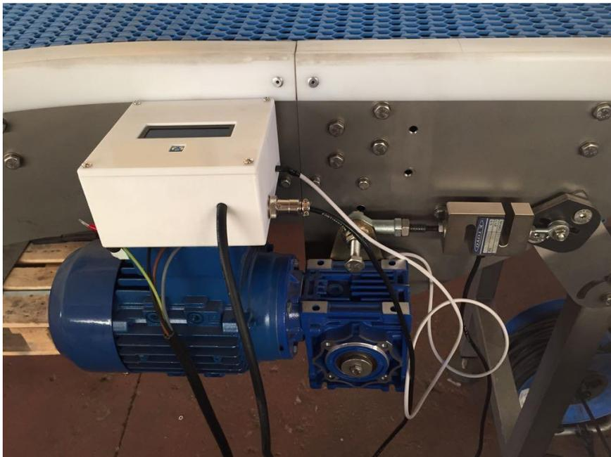
Figura 100. Posicionamiento de la célula de carga (Fuente: Propia)
