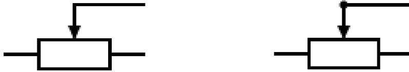
Figura 32: Otra simbología del potenciómetro (Fuente: simbología-electrónica)
