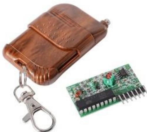
Figura 37: Kit de comunicación simple, mando con XY-DJM-5V (Fuente: Google)
