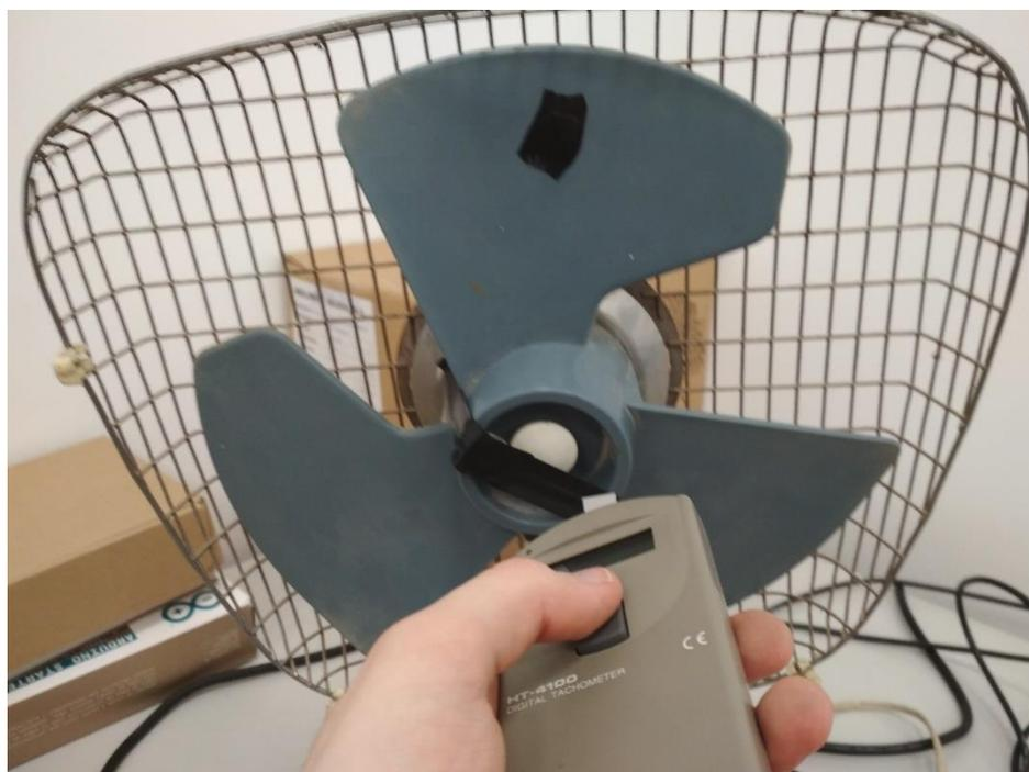
Figura 98: Distancia entre 20 y 300 mm entre el tacómetro digital y el adhesivo (Fuente: Propia)
