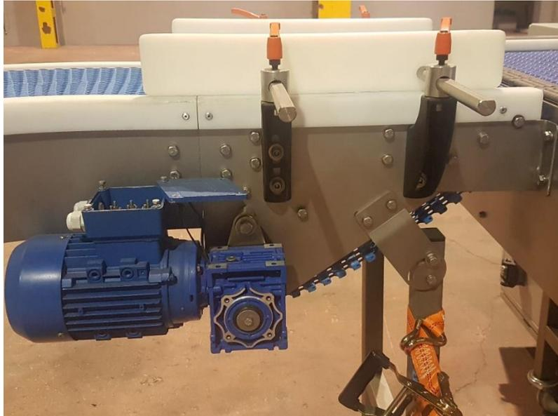
Figura 99: Cinta transportadora (Fuente: PCS INNOVATIONS S.L.)
