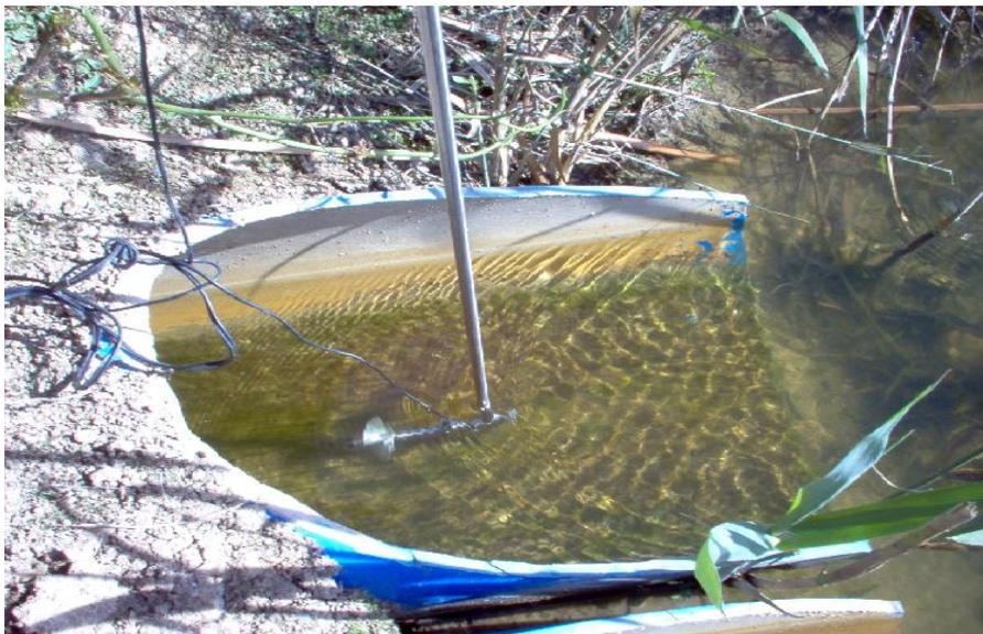
**Figura 25. Posición del minimolinete en la tubería de la compuerta de salida.**
