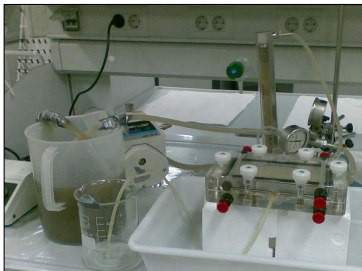
Previamente a poner en funcionamiento la instalación se ha de preparar el recorte de la membrana y colocarlo adecuadamente en el módulo Rayflow.
