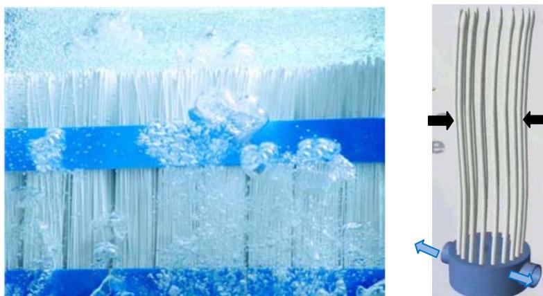
Las fibras no están tensas, sino que tienen una cierta holgura, de manera que durante el funcionamiento normal están en movimiento. Este factor, según el fabricante previene la creación de una capa de sólidos alrededor de las fibras, y reduce su ensuciamiento.
