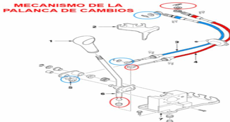
*Ilustración 6. Mecanismo de palanca de cambios.*
