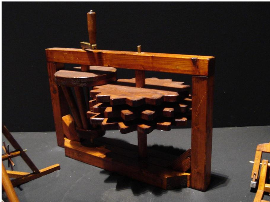
*Ilustración 1. Primera caja de cambios diseñada por Leonardo Da Vinci.*
