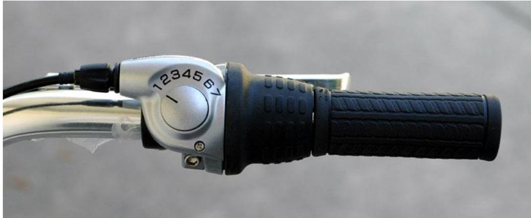
*Ilustración 9. Cambio de bicicleta en el manguito.*
