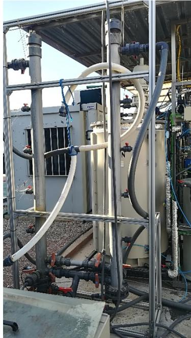
Figura 12. Módulo de membranas de ultrafiltración empleado
