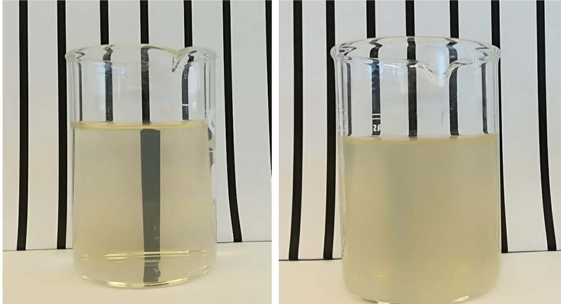
Figura 16. Comparación visual del permeado obtenido (izquierda) y el agua decantada de entrada (derecha) al trabajar con un flujo de permeado de 16.2 LMH
