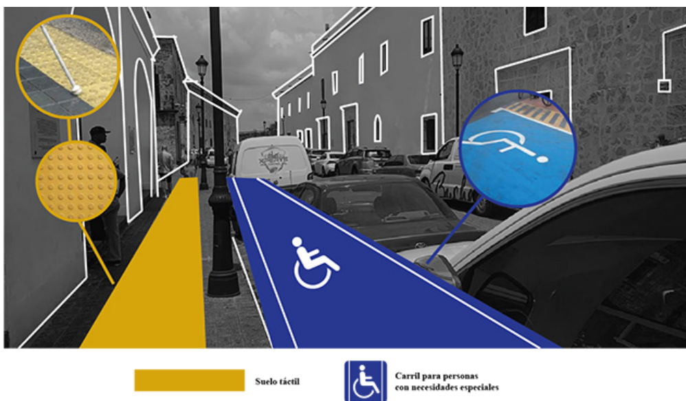
Figura 48. Pavimento podotáctil y carril para usuarios en sillas de ruedas en la calle Las Damas
