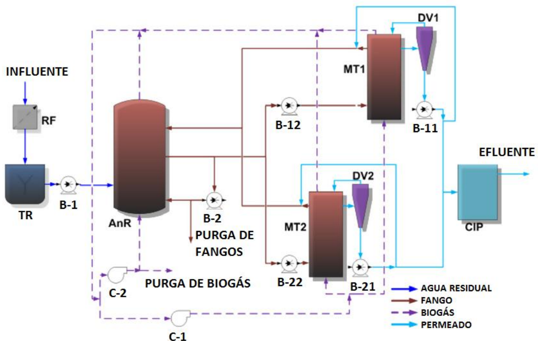
Figura 6: Esquema de la planta piloto (Giménez et al., 2011).
