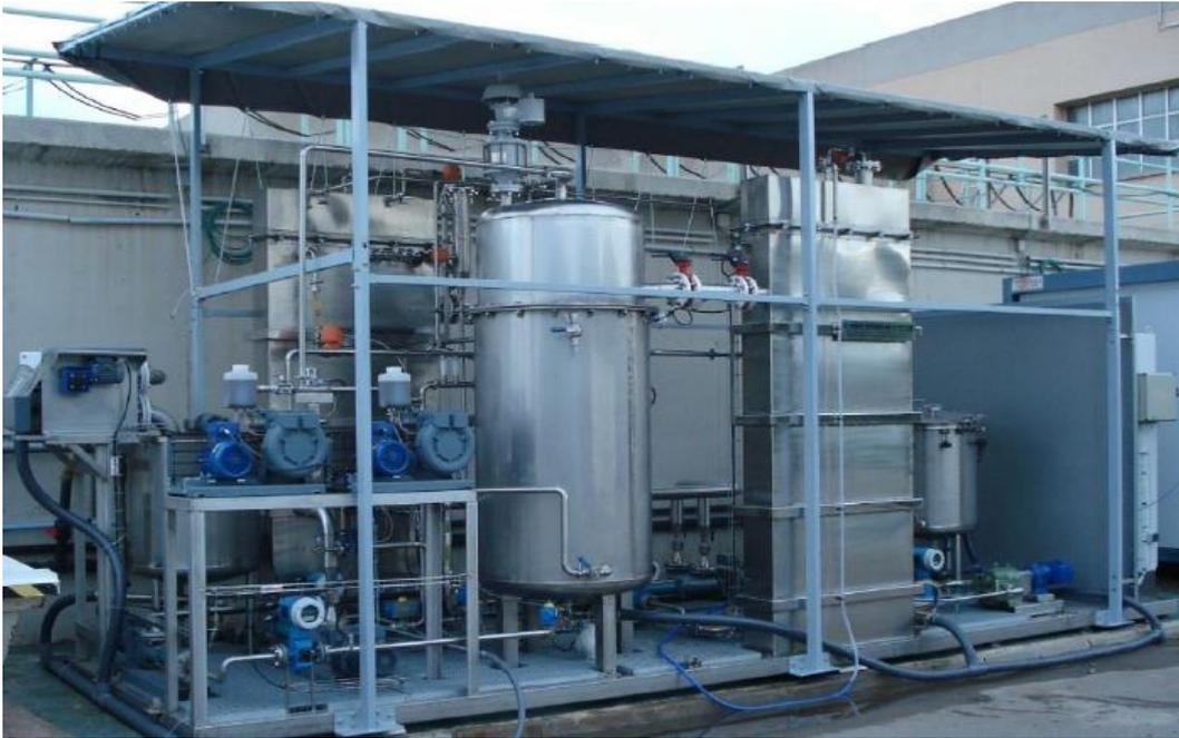
**Figura 3.1.** Vista general de la planta AnMBR a escala piloto industrial.
