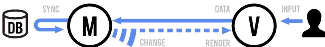
Figura 6.7: Esquema de modelo-vista de *BackboneJs*
