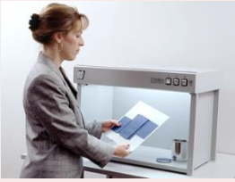
Figura 10. Cabina de luz para la observación de atlas de color. ( http://sensing.konicaminolta.com.mx/2015/04/mejores-practicas-para-evaluar-visualmente-el-color-de-las-muestras/ )
