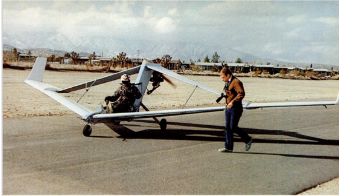
Figura 1.4: Primer modelo real de Joint Wing, con Wolkovitch como piloto Schefter 1986.
