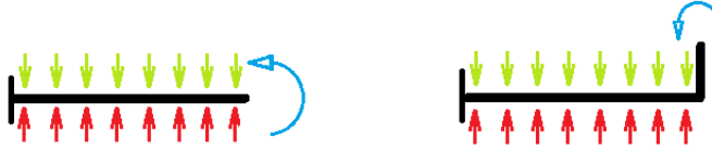
Figura 1.5: Efecto de un winglet sobre el flujo de aire generado por la diferencia de presión entre intrados y extrados
