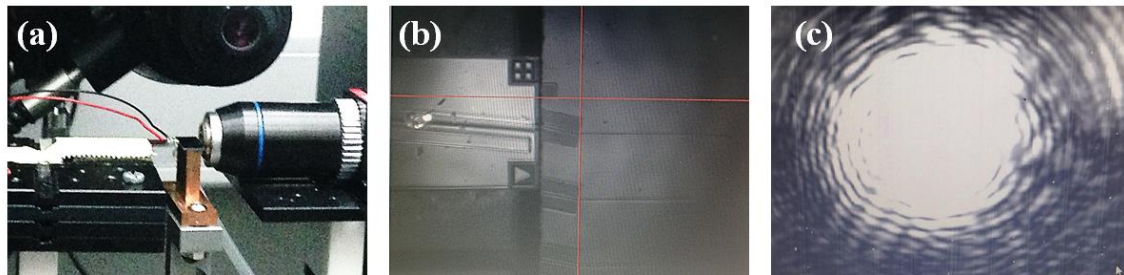
Figura 4.24: (a) Alineamiento activo del chip de ganancia QD respecto a objetivo. (b) Alineamiento del QD al puerto de entrada de la muestra. (c) Punto de luz visualizado en la cámara de infrarrojo después del alineamiento.
