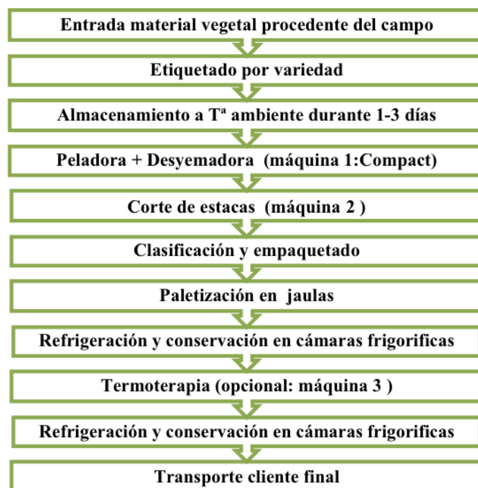
Figura 17. Diagrama proceso de obtención de estacas mediante máquinas semiautomáticas. (Fuente: Elaboración propia).
