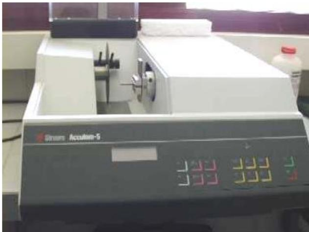
*Figura 7.7. Cortadora Accutom-50.*
