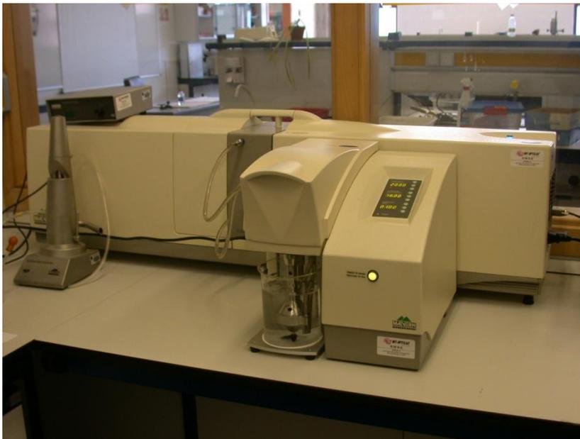
*Figura 7.3. Equipo de medida de tamaño de partícula mediante laser.*
