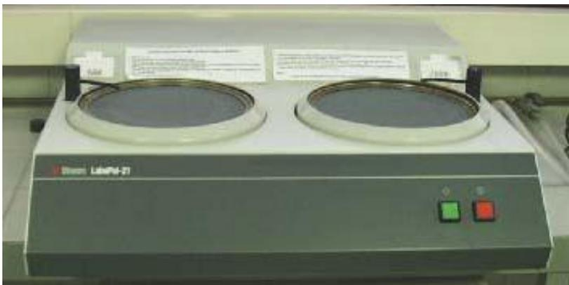
*Figura 7.9. Platos giratorios para preparar muestras metalográficas.*
