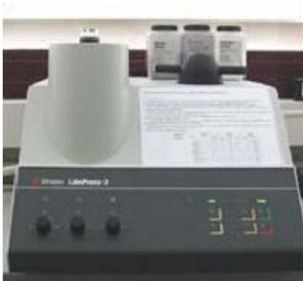
*Figura 7.8. Equipo para embutir muestras metalográficas.*
