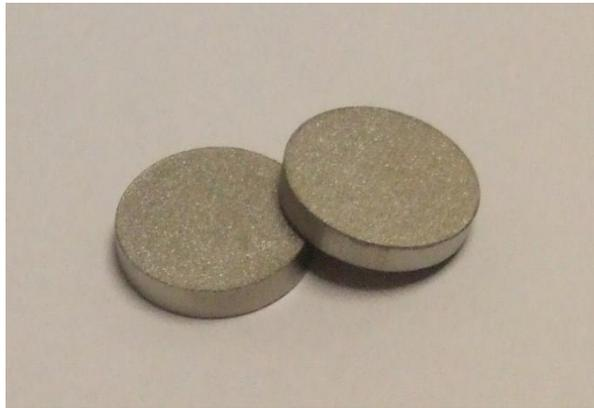
*Figura 7.6. Probetas obtenidas después de sinterizado.*
