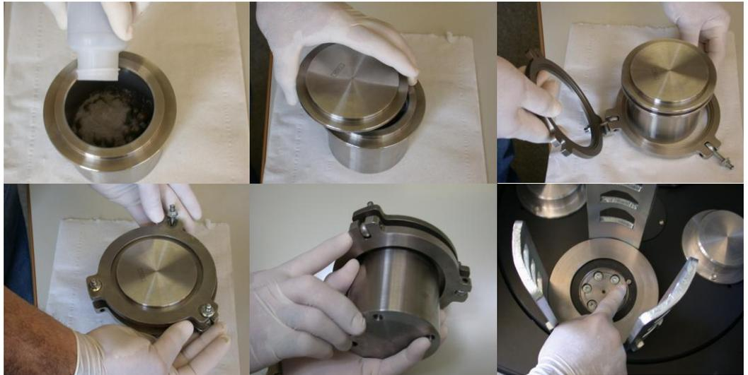
*Figura 7.2. Llenado de las jarras del molino planetario.*
