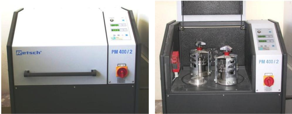
*Figura 7.1. Molino planetario.*
