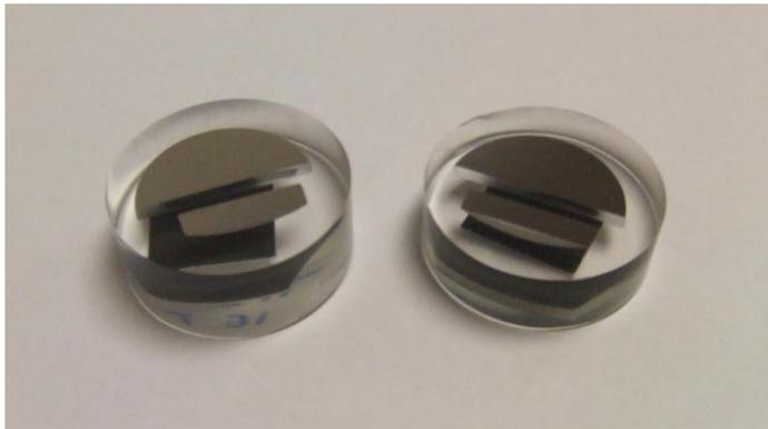
*Figura 7.10. Muestras preparadas para metalografía.*
