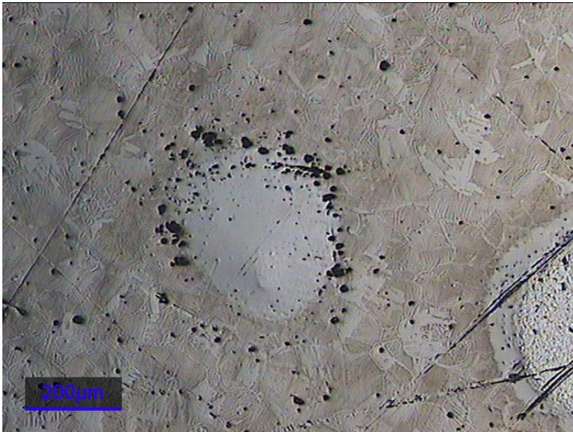
*Figura 8.19. Detalle de una partícula de molibdeno en la muestra n17.*
