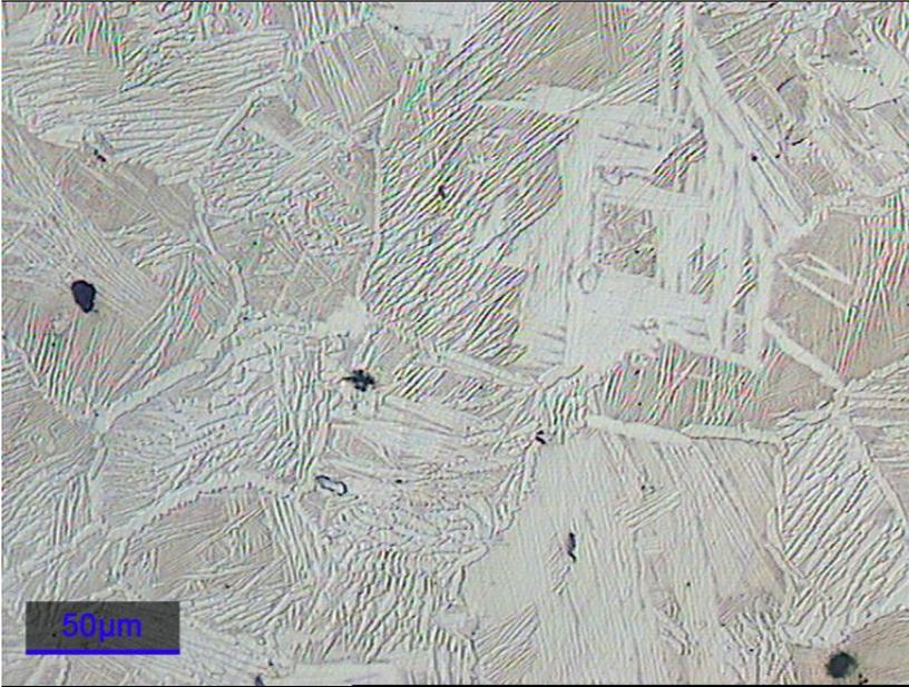
*Figura 8.20. Microestructura  $\alpha + \beta$  de la muestra n17.*
