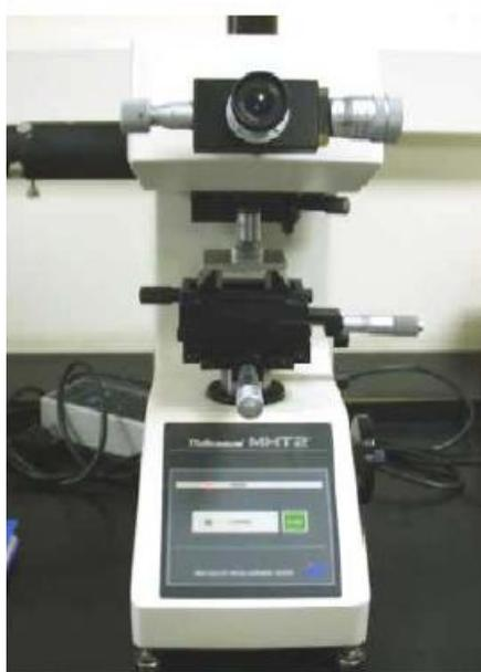
*Figura 7.11. microdurómetro Matsuzawa MHT2.*
