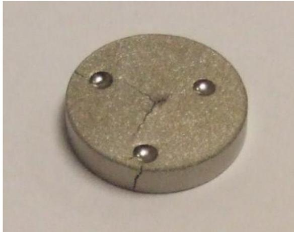
*Figura 8.36. Imagen de las probetas después del ensayo de flexión biaxial.*
