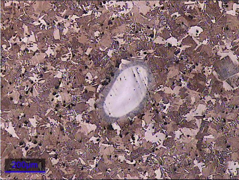
Figura 8.21. Detalle de una partícula de molibdeno en la muestra n18.
