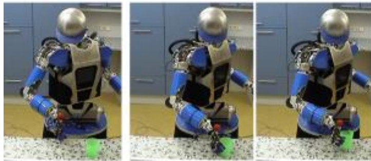
Figura 2.10: Armar-III realizando el agarre de un vaso.
