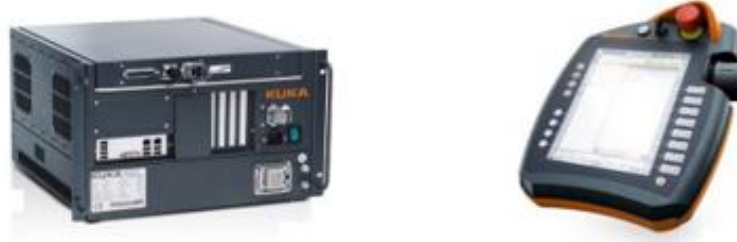
Figura 4.3: Controlador KR C4 Compact (izquierda) y KUKA smartPAD (derecha).
