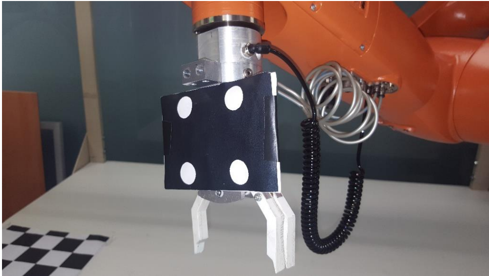
Figura 4.2: Detalle de la pinza acoplada al brazo.
