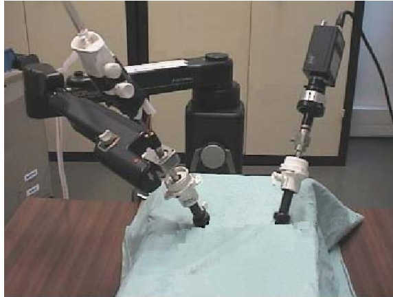
Figura 2.8: Control por visión de robot para operaciones de endoscopia
