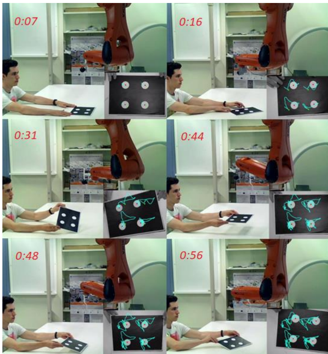
Figura 4.6: Experimentación con configuración eye-in-hand y algoritmo IBVS
