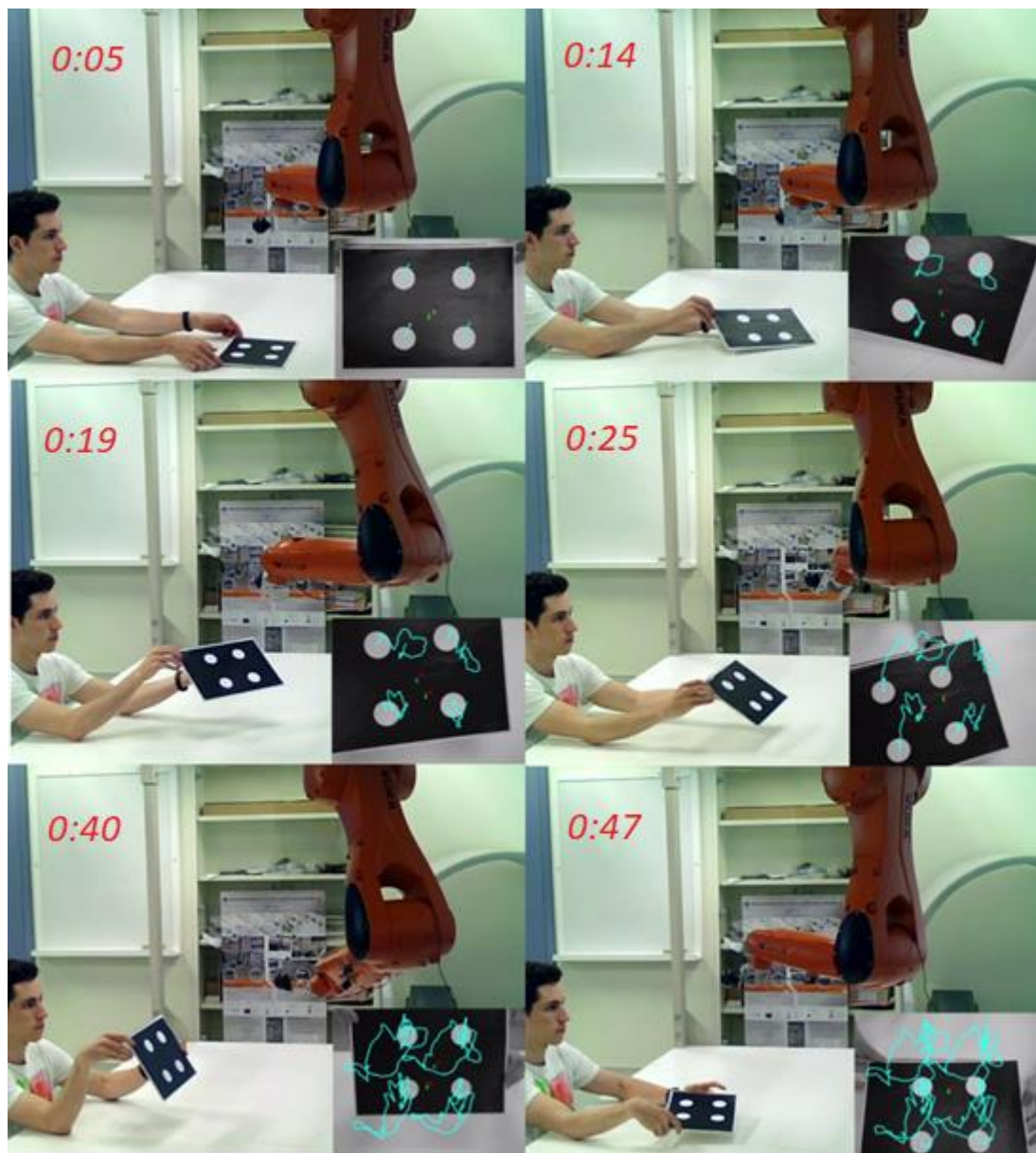
Figura 4.9: Experimentación con configuración eye-in-hand y algoritmo PBVS
