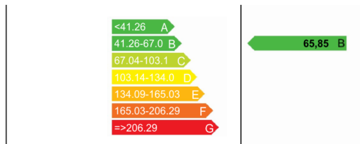
Figura 6 Calificación energética consumo de energía primaria no renovable del colegio Ramón Laporta. Fuente: Documento Oficial de Certificación Energética realizado por la arquitecta Elena Martínez.
