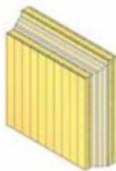
Figura 27 Composición tipo de la partición interior de CLT. Fuente: StoraEnso (2018).
