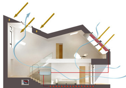
Figura 1.1. Esquema de ventilación y captación solar
