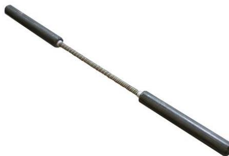
Figura 3.2. Barra FRP dispuesta con los anclajes de sujeción.
