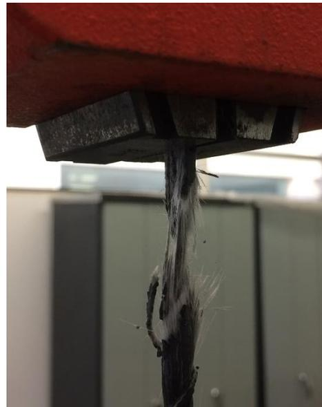
Figura 3.17. Rotura superior de una barra GFRP.
