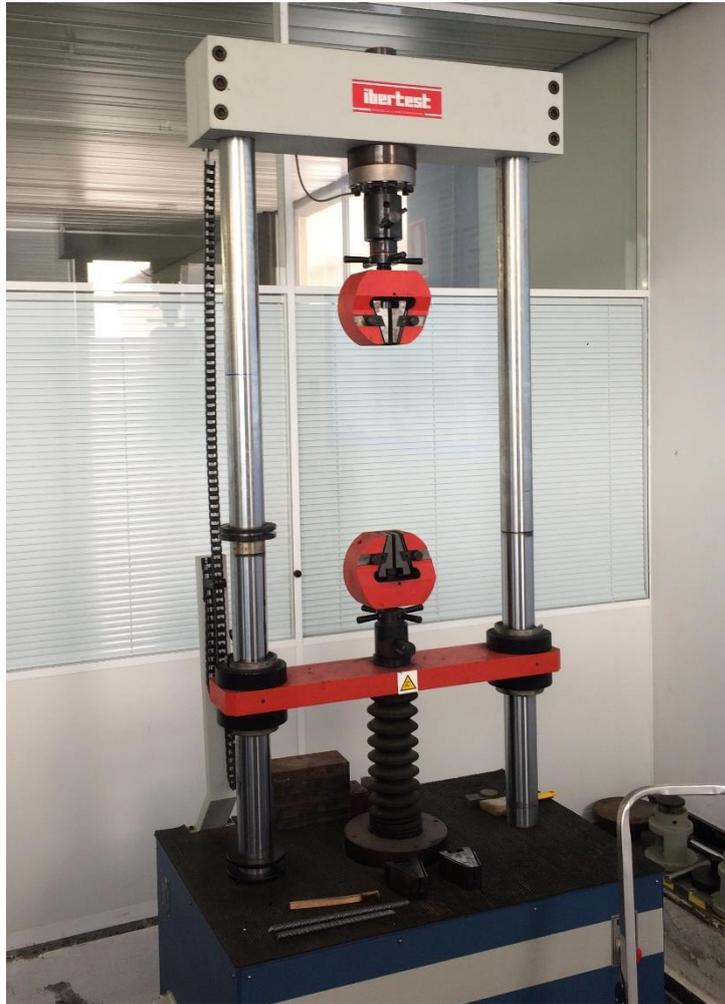
Figura 3.3. Máquina electromecánica universal IBEREST modelo STIB – 200/W.
