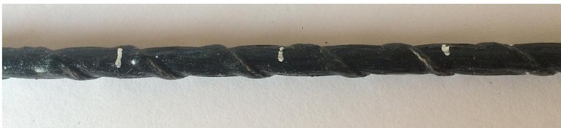
Figura 3.8. Barra corrugada GFRP.
