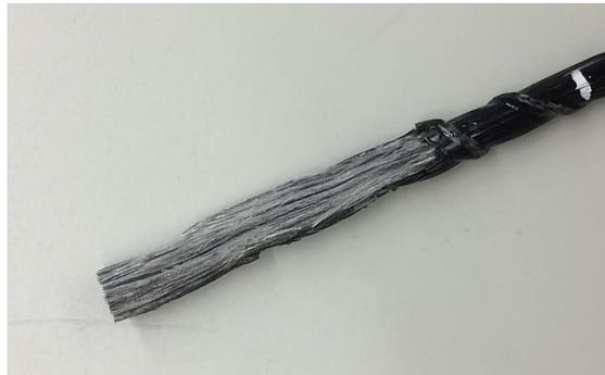
Figura 3.14. Extremo trabajado de una barra GFRP.
