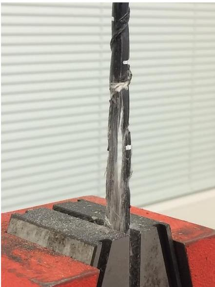
Figura 3.16. Rotura inferior de una barra GFRP.
