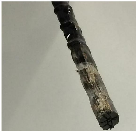
Figura 3.19. Extremo trabajado de una barra BFRP.
