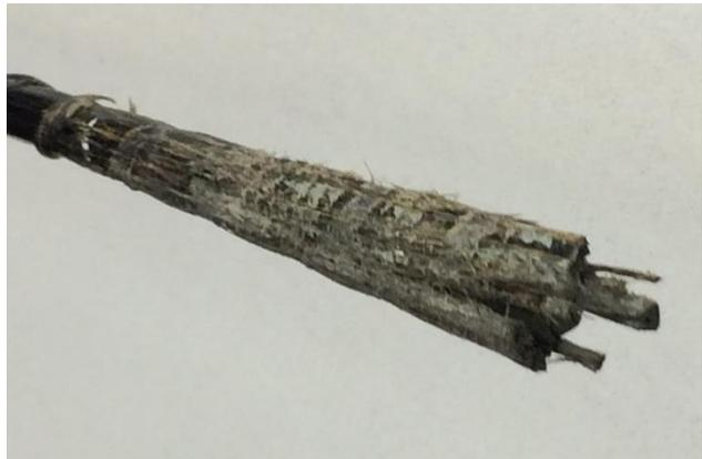
*Figura 3.23. Rotura con pérdida de sección de una barra BFRP*
