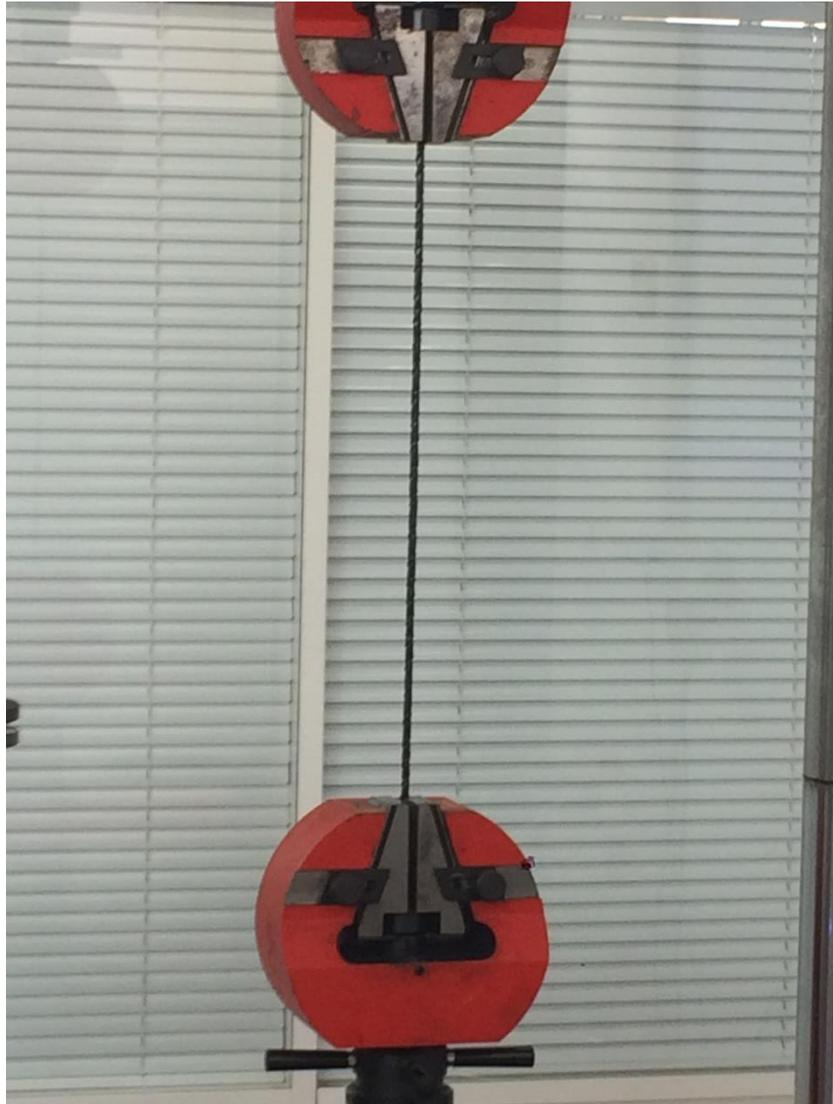
*Figura 3.21. Ensayo a tracción barra corrugada BFRP.*
