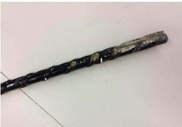
*Figura 3.22. Rotura del extremo de una barra BFRP*
