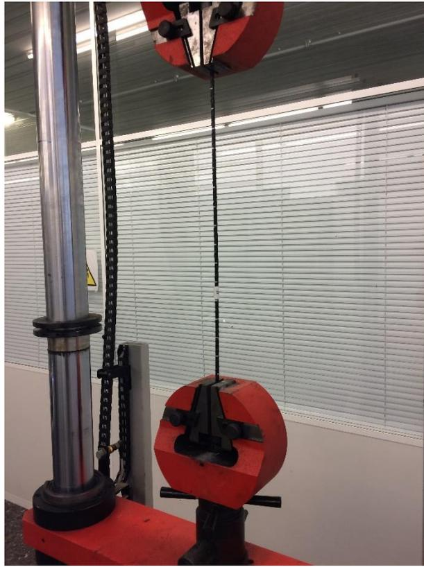
Figura 3.15. Ensayo a tracción barra corrugada GFRP.
