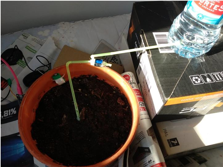
Visión general del sistema. La botella ha sido conectada mediante un tubo a la válvula, la cual ha sido fijada en la maceta. Del otro extremo de la válvula sale otro tubo que reparte el agua por la maceta.
