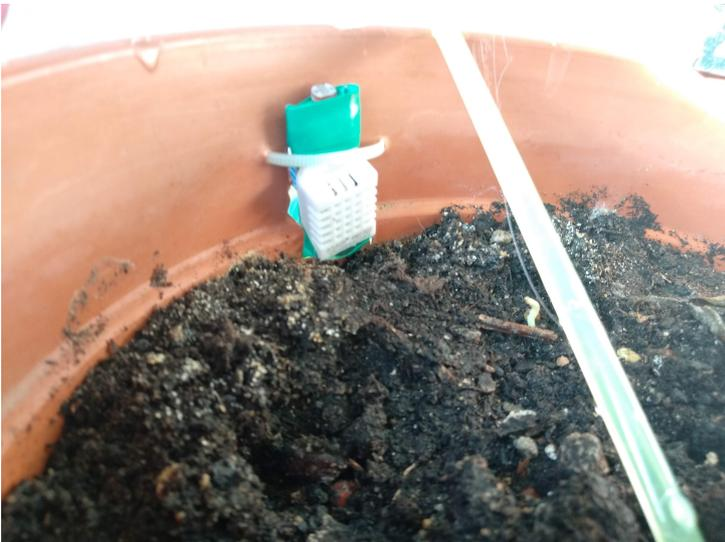
La colocación de los sensores próxima al tubo de riego es causada para la correcta medición de la humedad ganada con el riego. En las pruebas se ha apreciado que cuando el sensor de humedad está lejos de la fuente de agua, el riego es excesivo. Esta estructura ha resultado ser la más efectiva para controlar el riego.
