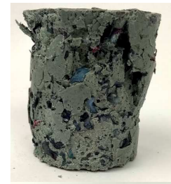
Imágenes 113. Primera muestra de la mezcla de los tres plásticos. Muestra con menos resistencia después de las pruebas. Elaboración propia
