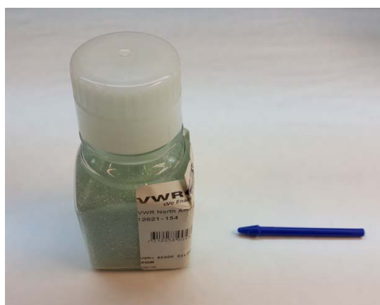
Figura 5. Microesferas y pistón usados para la homogeneización.
