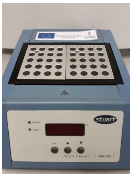
Figura 7. Block heater usado para la homogeneización por ciclos frío-calor.
