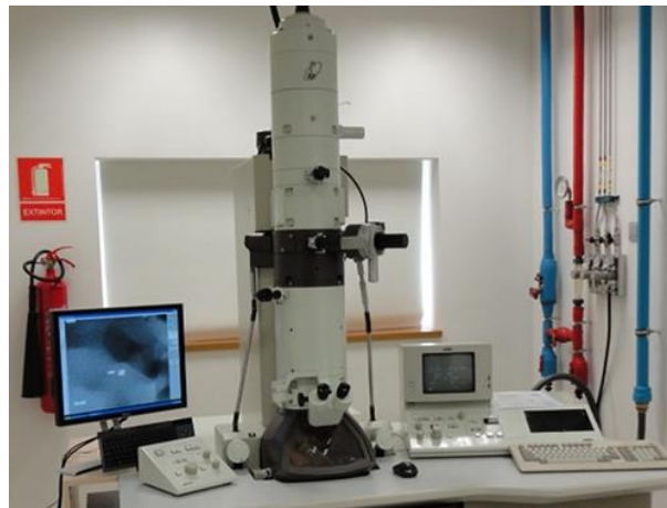
Figura 18: Microscopio Electrónico de Transmisión del servicio de Microscopía de la UPV (empleado)
