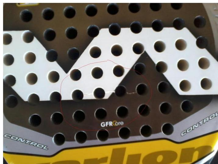
En cambio en esta imagen se observa como la fractura se ha producido en los orificios de los que dispone la raqueta.
