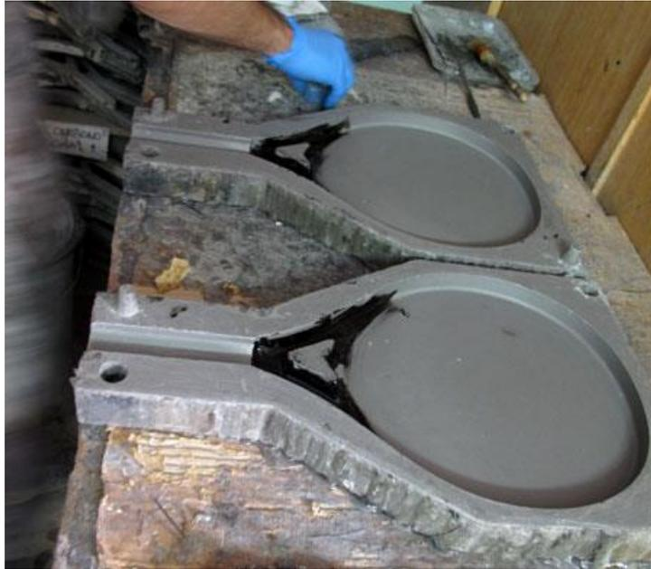
En la matriz se coloca primero unas láminas de resina epoxi con fibra de vidrio o carbono. Dependiendo de la cantidad de láminas que pongamos, tendrá unas especificaciones u otras.
