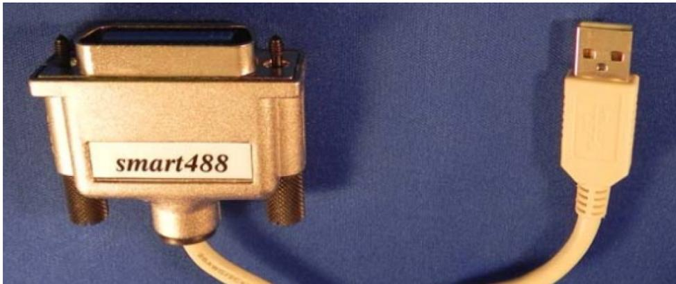
La utilización de un adaptador con conexión USB al ordenador nos permite poder conectar la fuente a cualquier ordenador sin que tengamos que tener que utilizar ni tarjeta PCI ni ningún tipo de hardware aparte.
