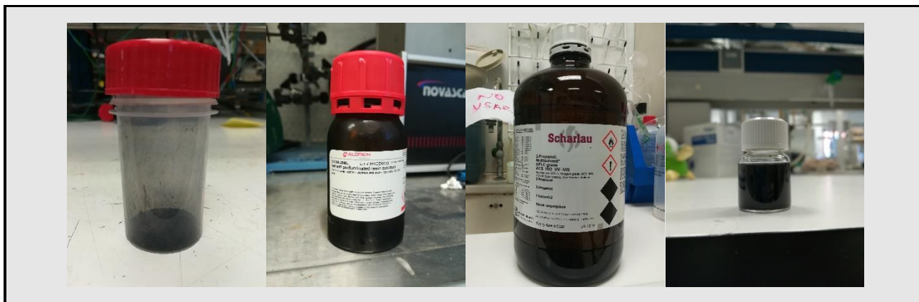
Imagen 2. De izquierda a derecha. Fotografía del electrocatalizador Cubano-Hom-1 , de la disolución de nafion al 5 %, del isopropanol y de la tinta catalítica.
