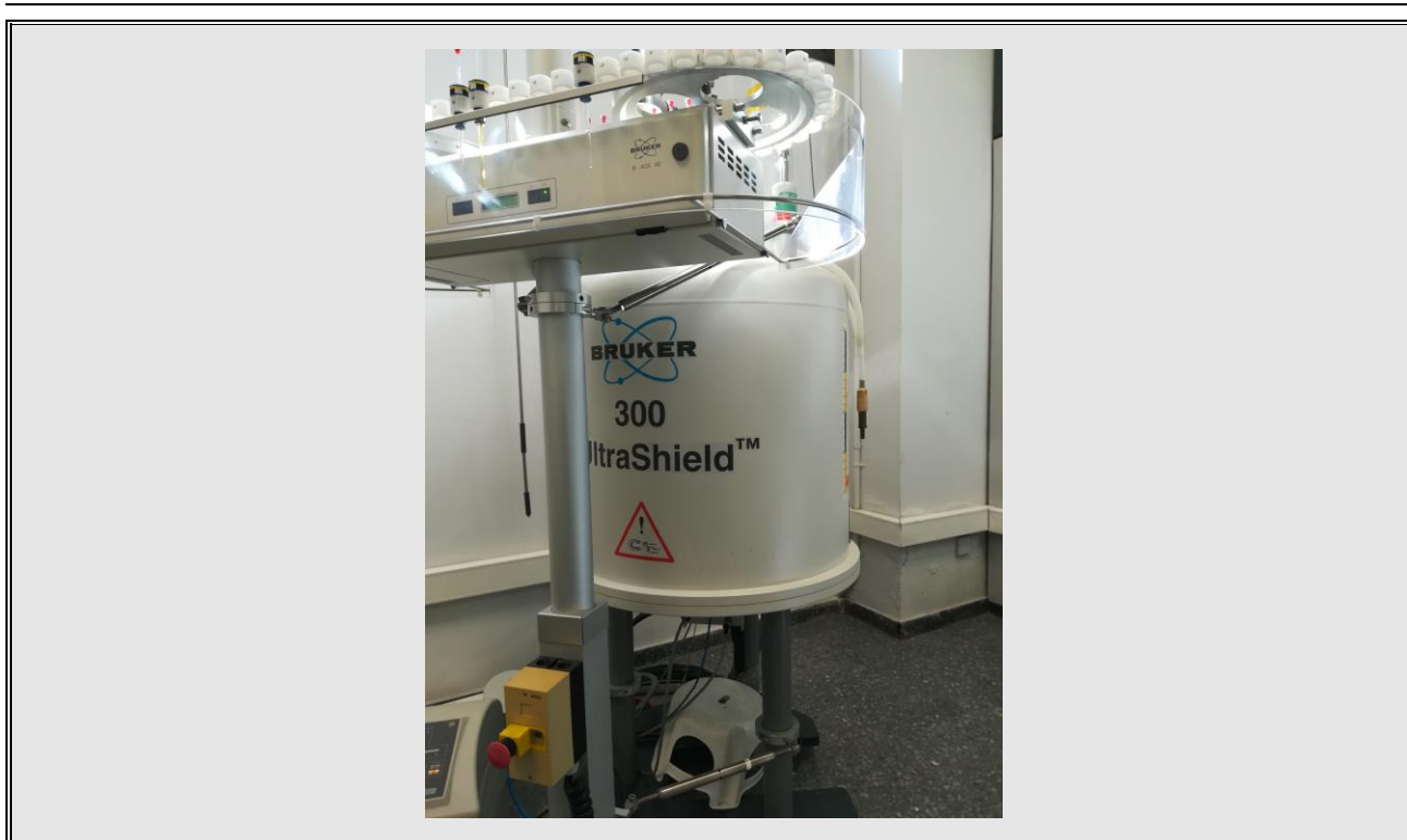
Imagen A3. Fotografía del equipo de Resonancia Magnética Nuclear de protón ( ^1\text{H} -RMN).
