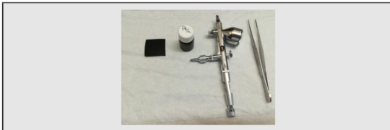
Imagen 3. De izquierda a derecha. Fotografía de la GDL (5 cm 2 ), tintas catalíticas de Pt/C, aerógrafo y pinzas metálicas.
