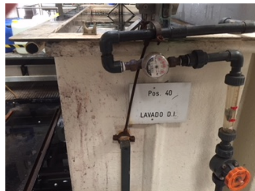
Figuras 13: se puede observar la cuba de pre sellado y el caudalimetro
