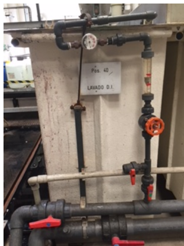
Figuras 13: se puede observar la cuba de pre sellado y el caudalimetro
