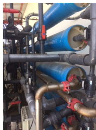
Figuras 16 y 17 equipo de osmosis inversa que hay en la planta actualmente y los filtros que utiliza
