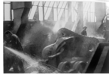
Fig. 50 Acabado de la superficie de las juntas de acero en taller
