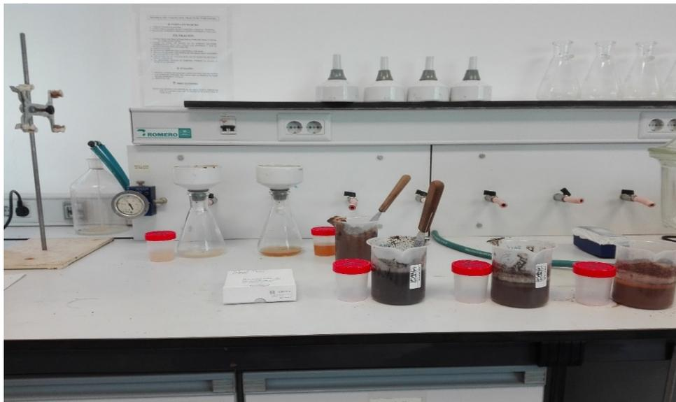
**Figura 29:** Primera filtración de la pasta saturada mediante un embudo Büchner. (Fuente: elaboración propia).
