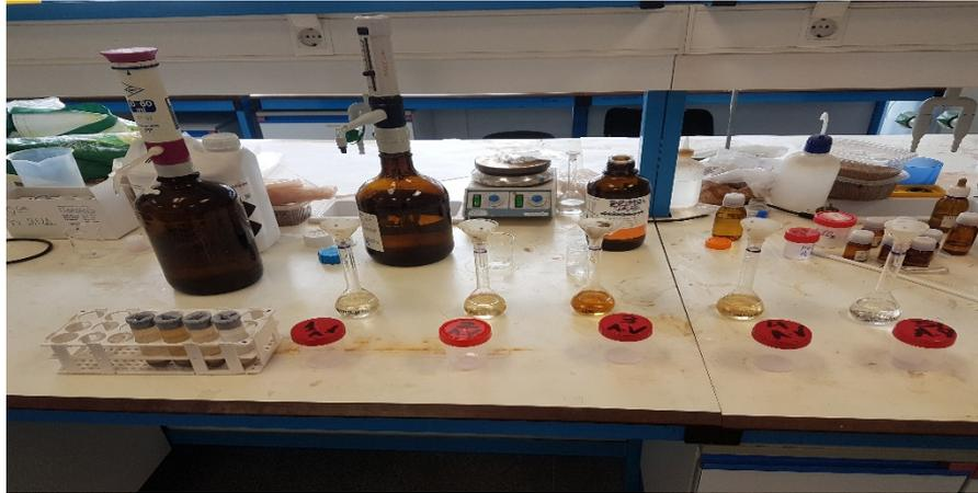
*Figura 33: Filtración convencional de la solución obtenida.*
