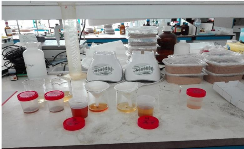
*Figura 30: Segunda filtración de la pasta saturada mediante un papel filtro y un embudo convencional. (Fuente: elaboración propia).*
