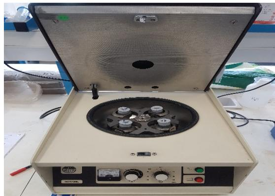
**Figura 32:** Centrifugación de las muestras.
