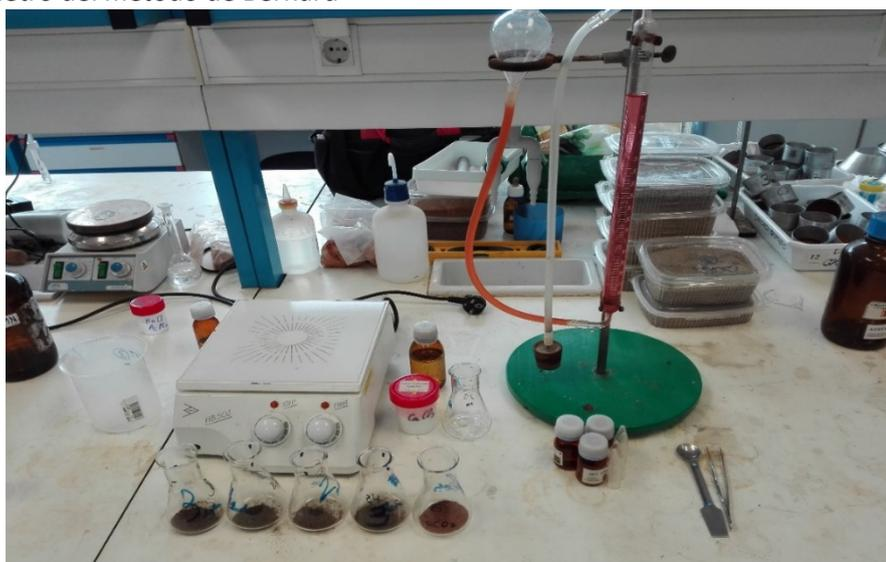
**Figura 25:** Determinación de la concentración de carbonatos mediante el método de Bernard. (Fuente: elaboración propia).
