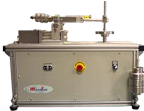
Ilustración 3 Tribómetro de Microtest
