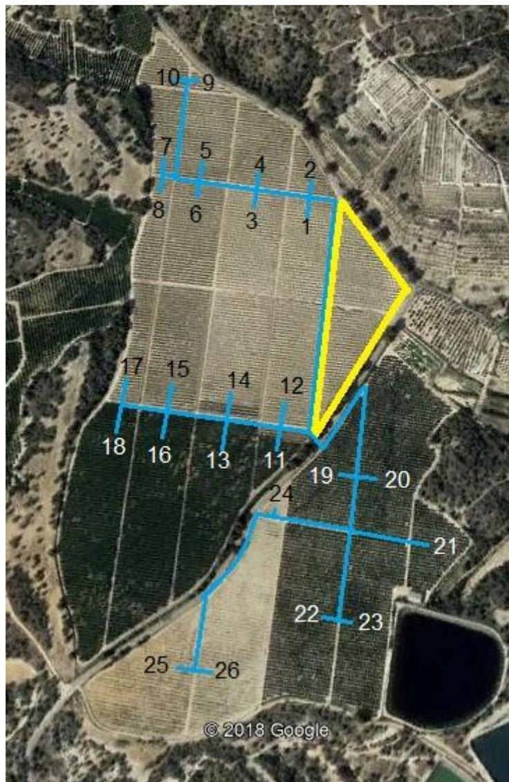
**IMAGEN 12. RED DE DISTRIBUCIÓN DE AGUA PARA EL SISTEMA DE RIEGO**
