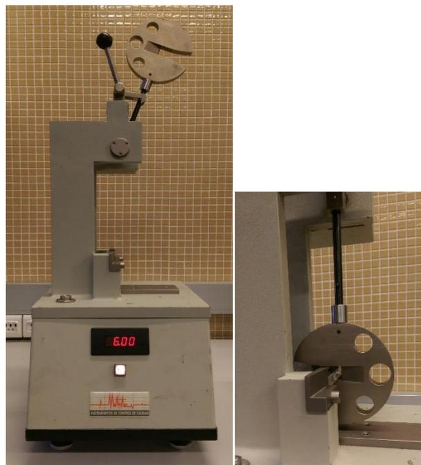
**Figura III. 3.6.** Equipo de impacto Charpy, Metrotec.
