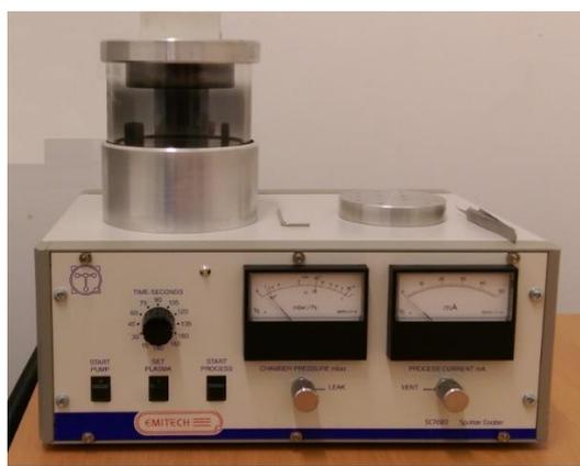
Figura III. 5.2. Sputter coater para metalizado de muestras.
