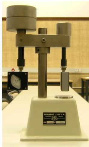
**Figura III. 3.5.** Durómetro Shore, con punta D y A.
