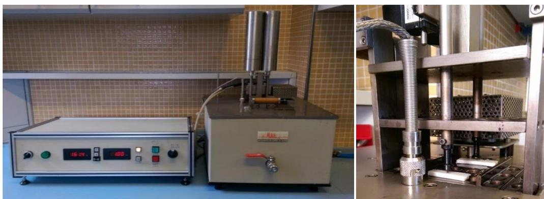
Figura III. 4.3. Equipo de medición VICAT, con penetrador de punta plana.
