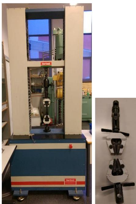
**Figura III. 3.1.** Máquinas de ensayo universal y mordazas de tracción.
