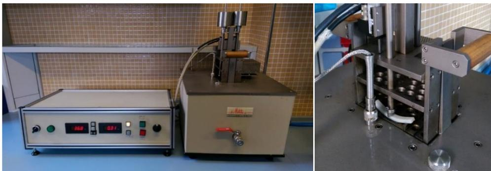
**Figura III. 4.4.** Equipo de medición HDT, con elemento de carga.
