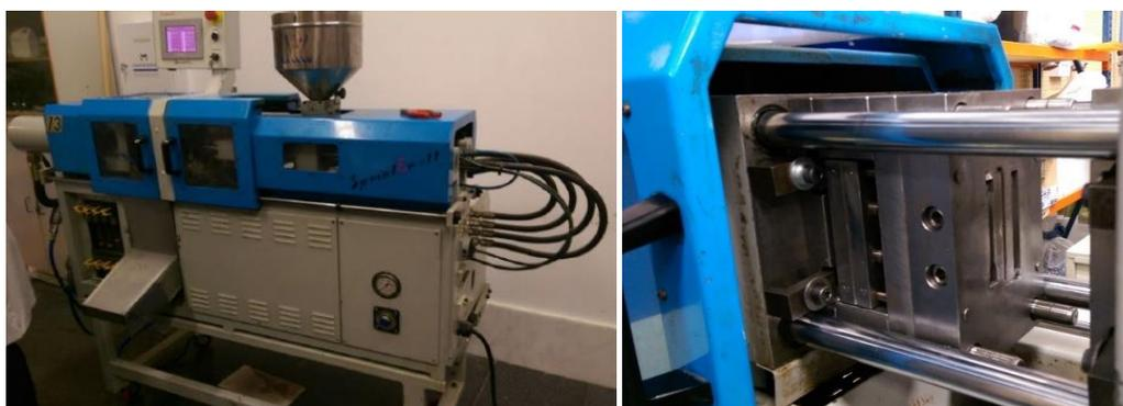
**Figura III. 2.2.** Máquina de inyección.
