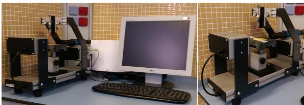
Figura III. 6.2. Goniómetro Easy Drop.
