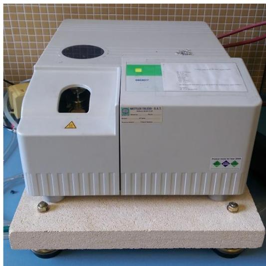
**Figura III. 4.1.** Equipo DSC METTLER TOLEDO.
