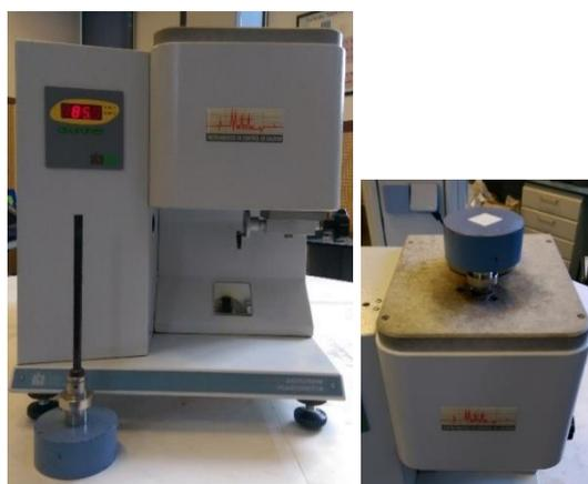
Figura III. 6.1. Plastómetro de extrusión METROTEC.
