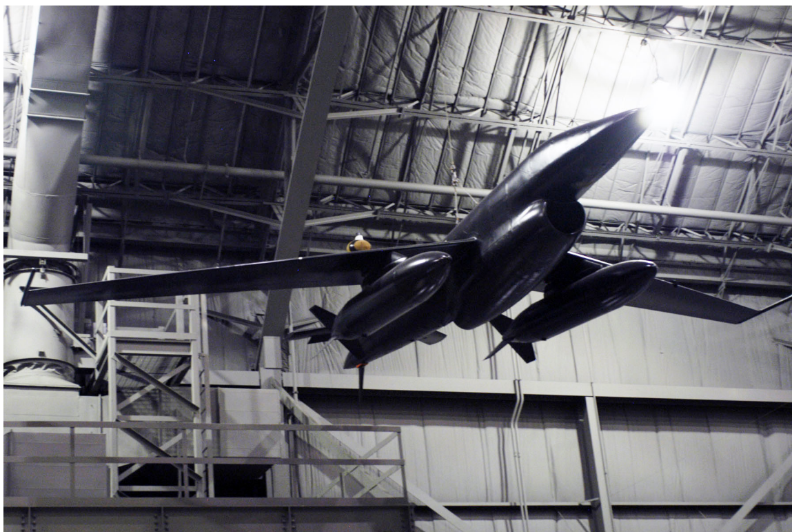
Figura 1.4 AQM-34Q, una de las muchas variaciones del drone de reconocimiento Ryan 147, usado en los años 1960s y 1970s
