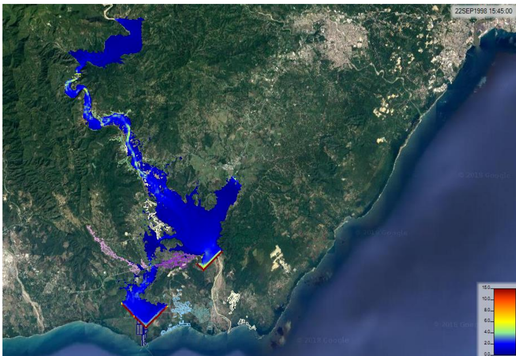
Figura 4. 32. Velocidades a los 240 minutos de la rotura de la presa. Tr 10000 años. Fuente: Elaboración propia.
