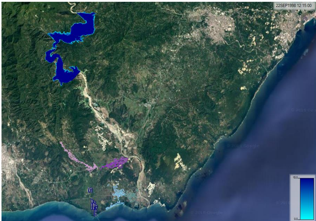
Figura 4. 22. Áreas potencialmente inundables a los 30 minutos de la rotura de la presa. Tr 10000 años. Fuente: Elaboración propia.
