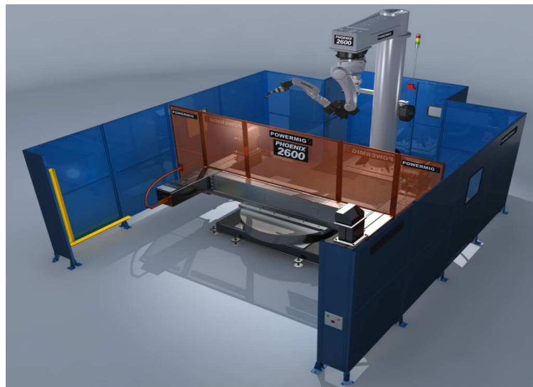
Figura 1.1: Celda soldadura mesa giratoria
