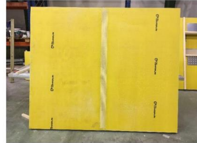
Fig. 8: Paneles unidos definitivamente mediante soldadura química.
