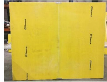
Fig. 6: Paneles unidos provisionalmente con adhesivo y pletina metálica.
