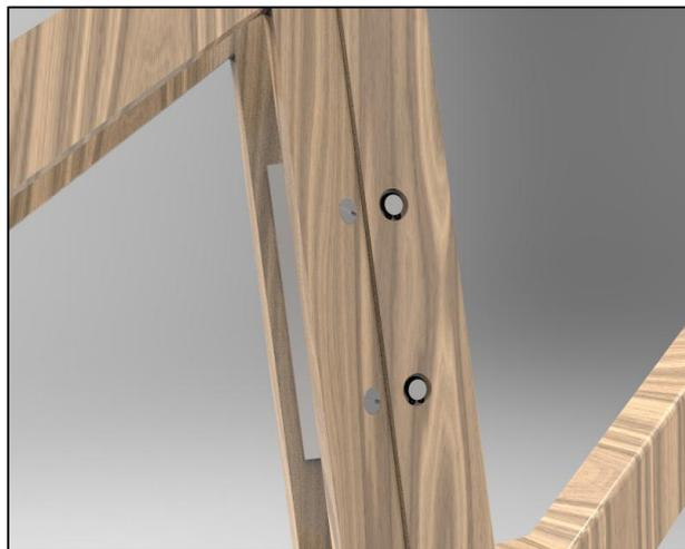
Figura 7.66 Sistema de unión en el ángulo
