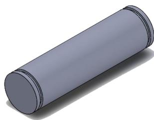
Figura 7.66.A Sistema de unión, bulón
