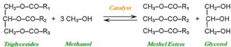
Fig. 1.3.3.1: Reacción de transesterificación de triglicéridos con metanol [166].
