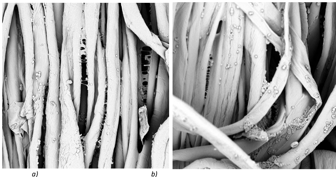
Figura 3. Fibras de algodón tratadas con microcápsulas (60 g/L) y resina (10 g/L). a) impregnación y b) pulverización.
