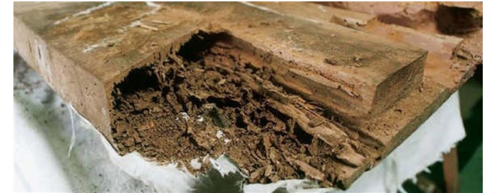
Fig. 9. Madera atacada por hongos de pudrición blanda. Fuente: ITM TRATAMIENTO DE LA MADERA. < http://www.itmtratamientos.es >
