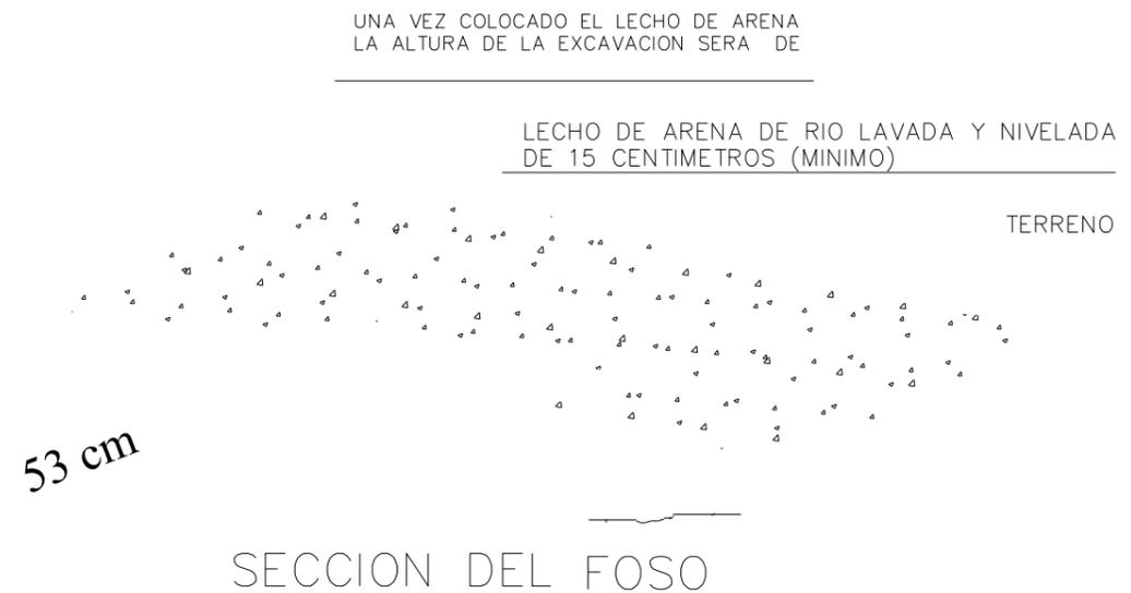
SITUAR EL MODULO DE HORMIGON CENTRADO EN LA EXCAVACION, DEJANDO 50 cm. POR SU FRENTE Y SU PARTE POSTERIOR, PARA PERMITIR LA EXTRACCION DE LOS UTILES DE IZADO.
