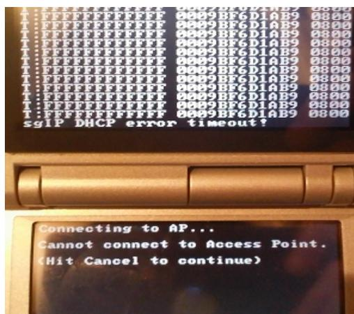
Figura 60: Fallo de conexión vía DHCP
