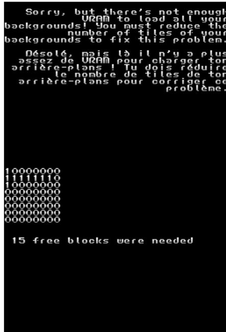
*Figura 34: Error por sobrecarga de fondos*
