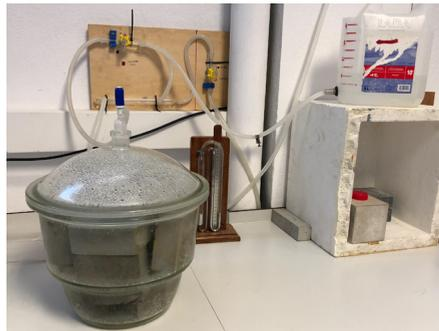
Fig. 57 Recipiente saturado y en vacío
