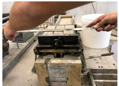
Fig. 33 Regulación del molde
