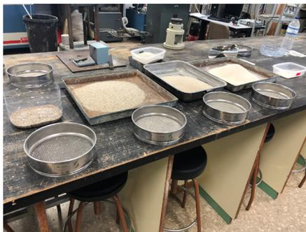
Fig. 24 Arena tamizada y separada
