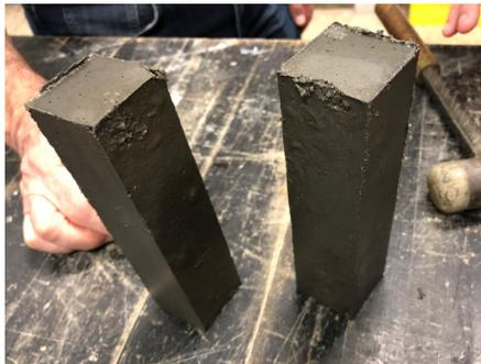
Fig. 50 Morteros de CV dañados
