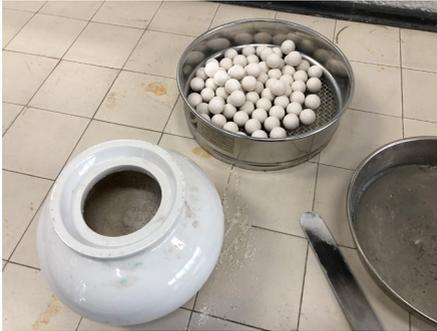
Fig. 16 Componentes molino de bolas
