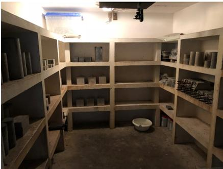
Fig. 34 Cámara de curado
