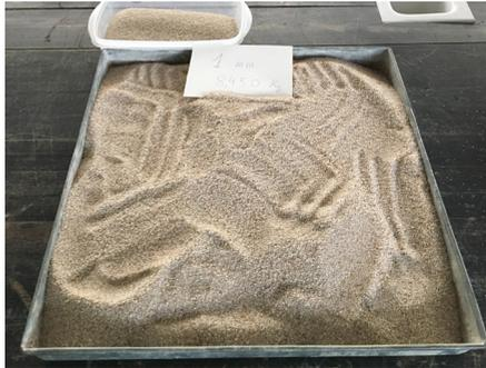
Fig. 20 Arena retenida en tamiz 1 mm
