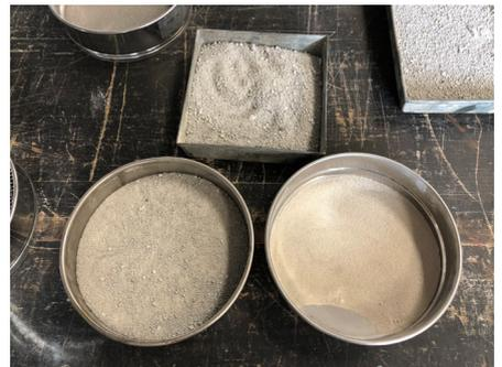
Fig. 13 Fases de molienda antes de Molino
