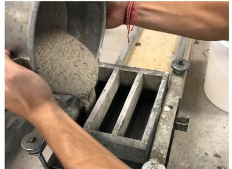
Fig. 31 Vertido de la mezcla al molde
