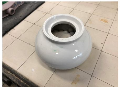
Fig. 15 Componente principal de Molino
