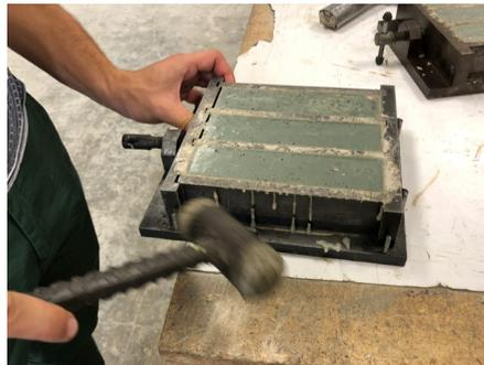
**Fig. 38** Desmoldando las piezas
