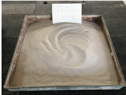
Fig. 22 Arena retenida en tamiz 0,125 mm
