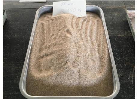
Fig. 21 Arena retenida en tamiz 0,5 mm
