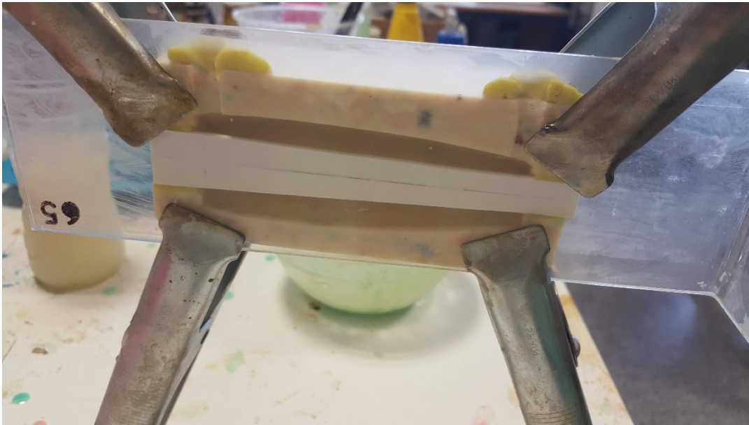
Figura 36 Molde mango preparado para colada
