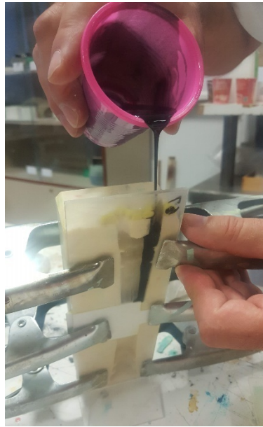
Figura 38 Colada molde guarda
