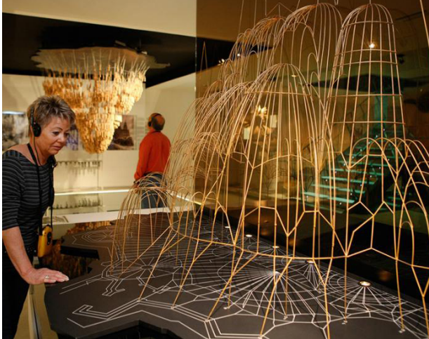
Figura 19. Maqueta funicular del sistema de arcos desarrollado por Gaudí.
