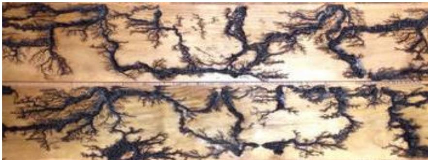
Figura 16 Paso de electricidad a través del agua de la madera
