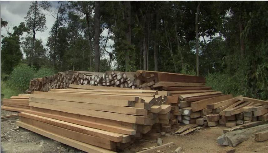
Figura 6 Piezas trabajadas de sección rectangular en aserradero
