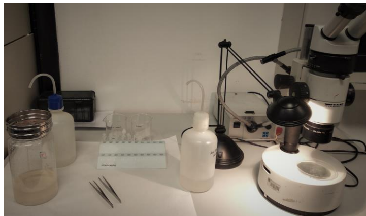
Imagen 3.15: Material necesario para el análisis e identificación de los microplásticos presentes en una muestra.
