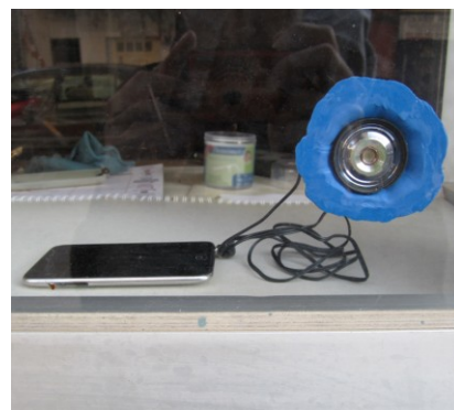
Prototipo del dispositivo emisor de audio a través del cristal. FIG90
