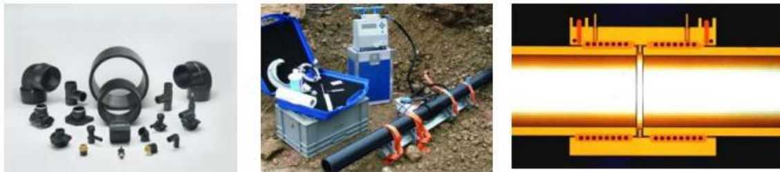
Figura 25: Soldadura con accesorios electrosoldables
