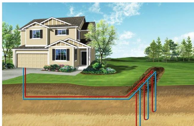
Figura 5: Intercambiadores verticales enterrados
