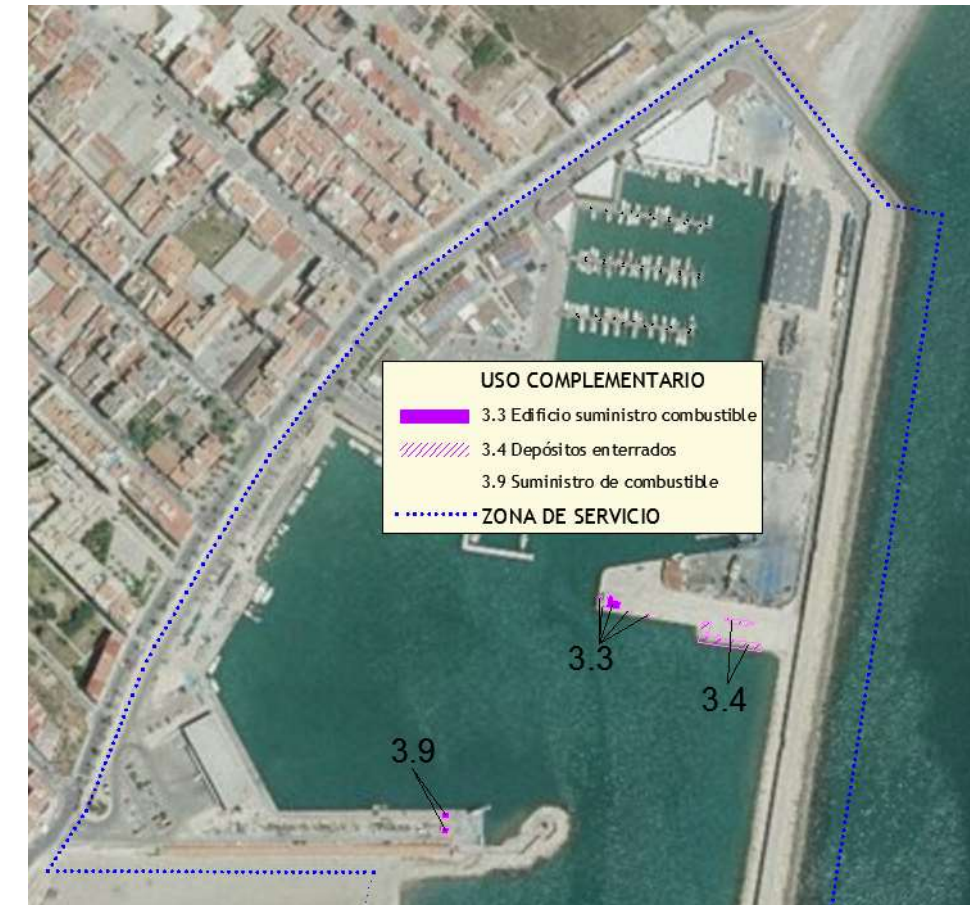
Ilustración 33. Esquema de la situación de los depósitos enterrados y suministro de combustible. Elaboración propia
